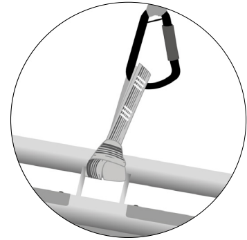
Imagen 3c: Fijación usando las eslingas de la barra
