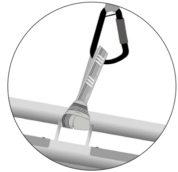
Bild 3c: Befestigung mithilfe der Bandschlingen
