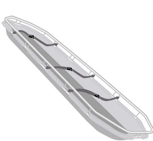
Imagen 3a: Fijación de cinturones de sujeción para pacientes en el SAN-0087-1- M
