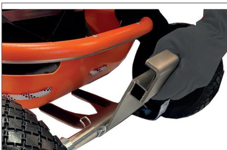
③ Fertig montierte Basisplatte am Rand der Korbtrage befestigen, indem man den Basisplatte-Winkel an den Korbtragen-Rand anflanscht. Bitte immer die Fuß-Seite der Korbtrage benutzen.
